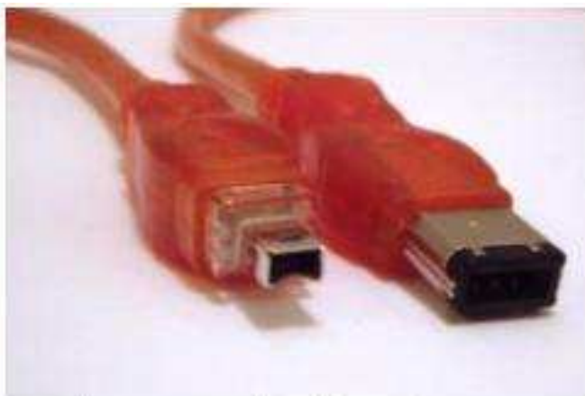
4-pinski (lijevo) i 6-pinski (dsno) FireWire konektori
