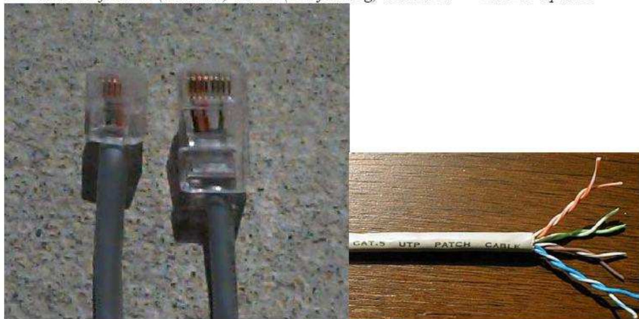
Poređenje RJ45 (Ethernet) i RJ11 (Telefonskog) konektora UTP sa 4 parice
